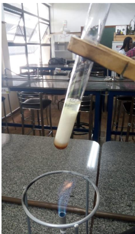
FIGURA 3: Amostra do leite sendo submetido à fervura do Bico de Bunsen. Fonte: Autoria própria.
