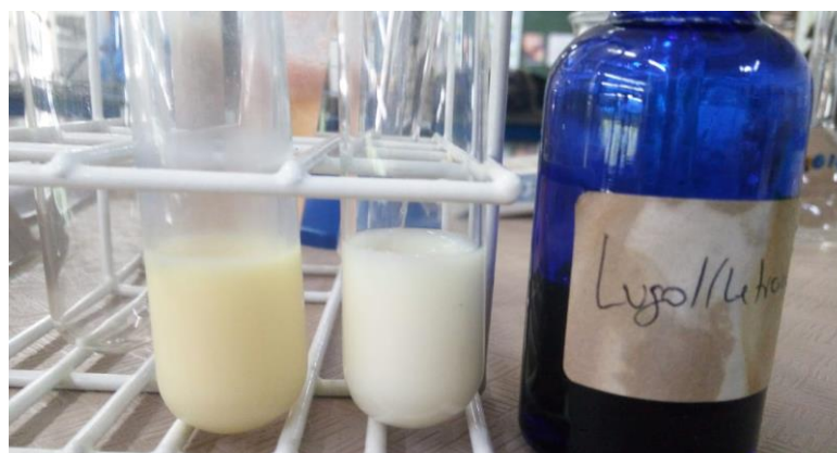
FIGURA 6: Coloração do leite cru e UHT respectivamente após a adição de Lugol. Fonte: Autoria própria.
